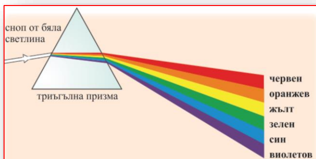
Спектър на светлината. Призмата разлага бялата светлина на ивици с различни цветове.
